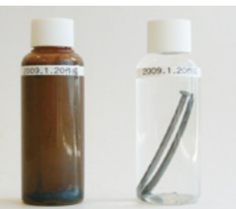
▲水道水 サビが発生し中が見えない ▲濃度10%のケイ素水 サビが発生していない
